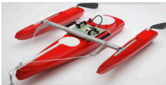
Рисунок 4 - Акустический профилограф фирмы Teledyne используется с плавательным средством без собственного двигателя
