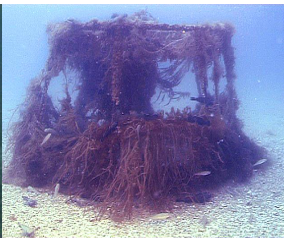
Рисунок 2 - Вид модуля экспериментальной станции через 3 месяца после постановки
