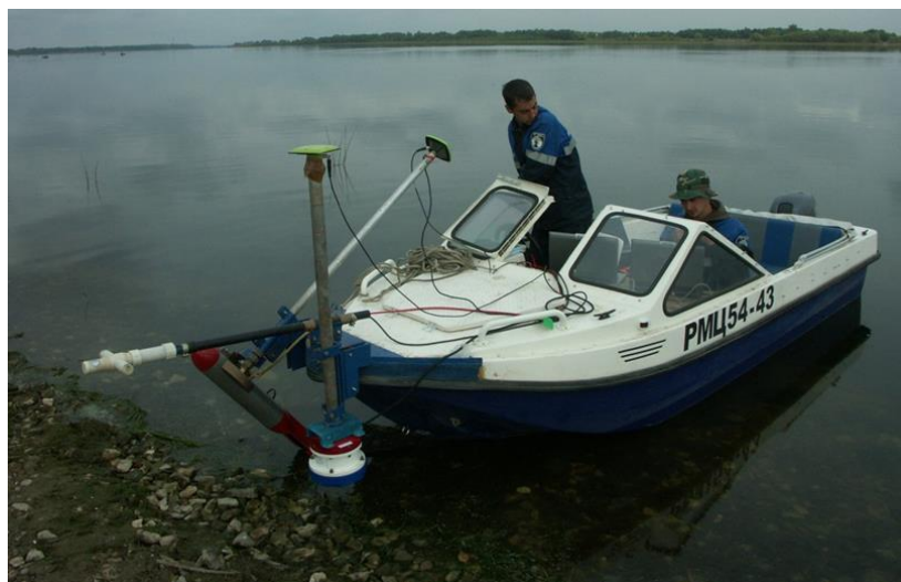
Рисунок 7 – Измерение скорости течения на определённой глубине с судна
