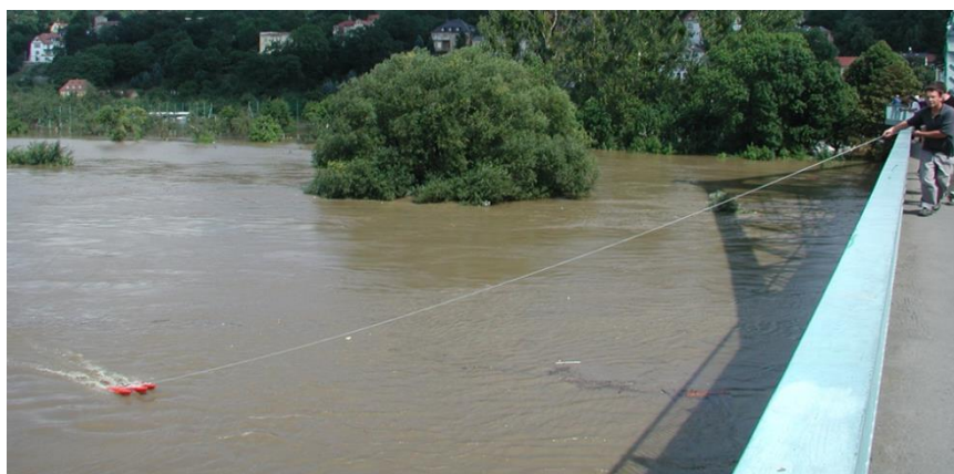
Рисунок 5 – Измерение скорости течения на определённой глубине с моста
