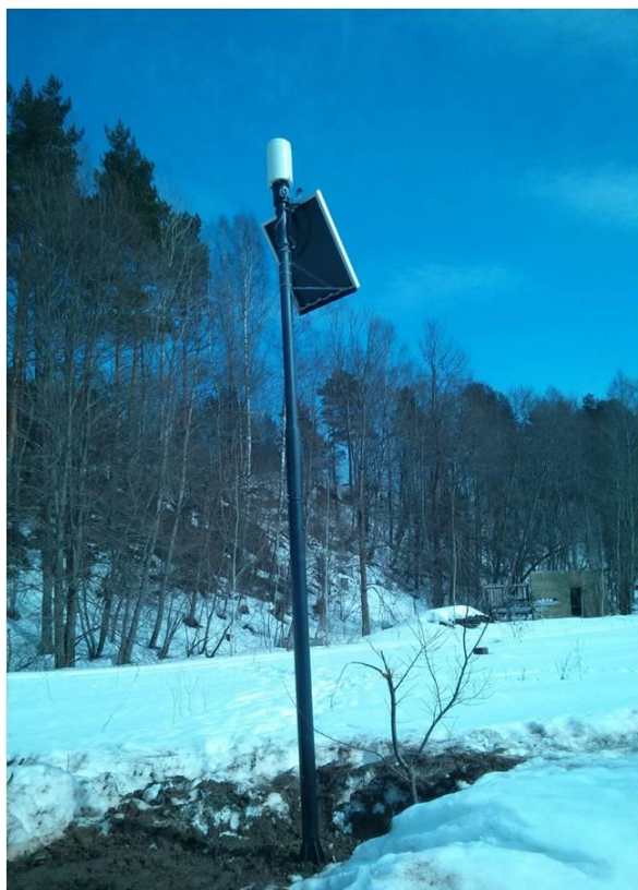
Рисунок 10 – Примеры практической организации наблюдений за колебаниями уровня и температурным режимом водотоков с помощью автономных автоматических гидрологических постов (ААГП)
