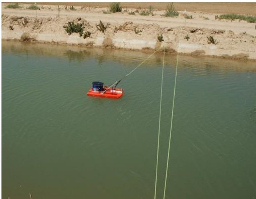
Рисунок 6 – Измерение скорости течения на определённой глубине с помощью перетяжки
