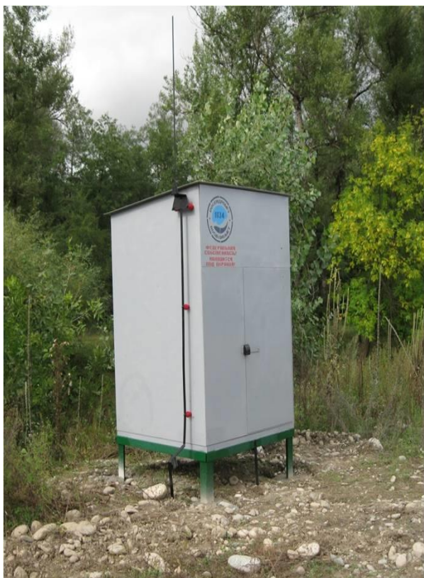
Рисунок 10 – Примеры практической организации наблюдений за колебаниями уровня и температурным режимом водотоков с помощью автономных автоматических гидрологических постов (ААГП)
