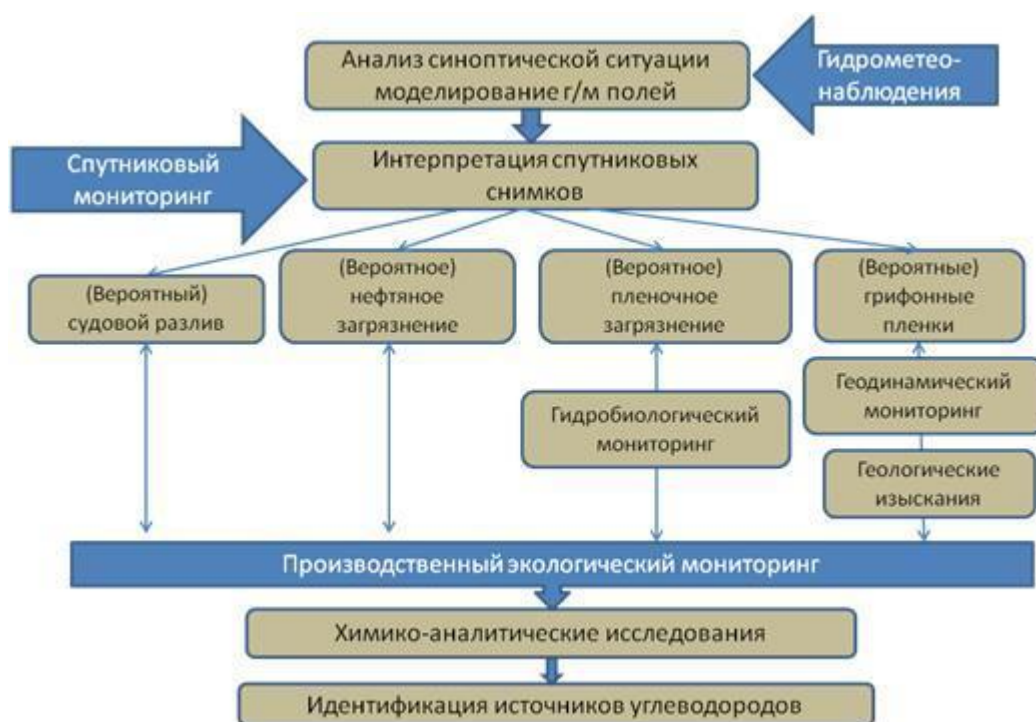
Рисунок 1 – Схема идентификации источников углеводородного загрязнения, опробованная ФГБУ «КаспМНИЦ»
