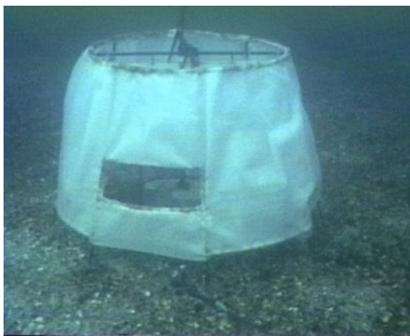
Рисунок 1 - Вид модуля экспериментальной станции, обтянутого полипропиленовой тканью в день постановки
