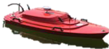
Рисунок 8 – Измерение скорости течения на определённой глубине с помощью измерительных комплексов Q-boat и Z-boat
